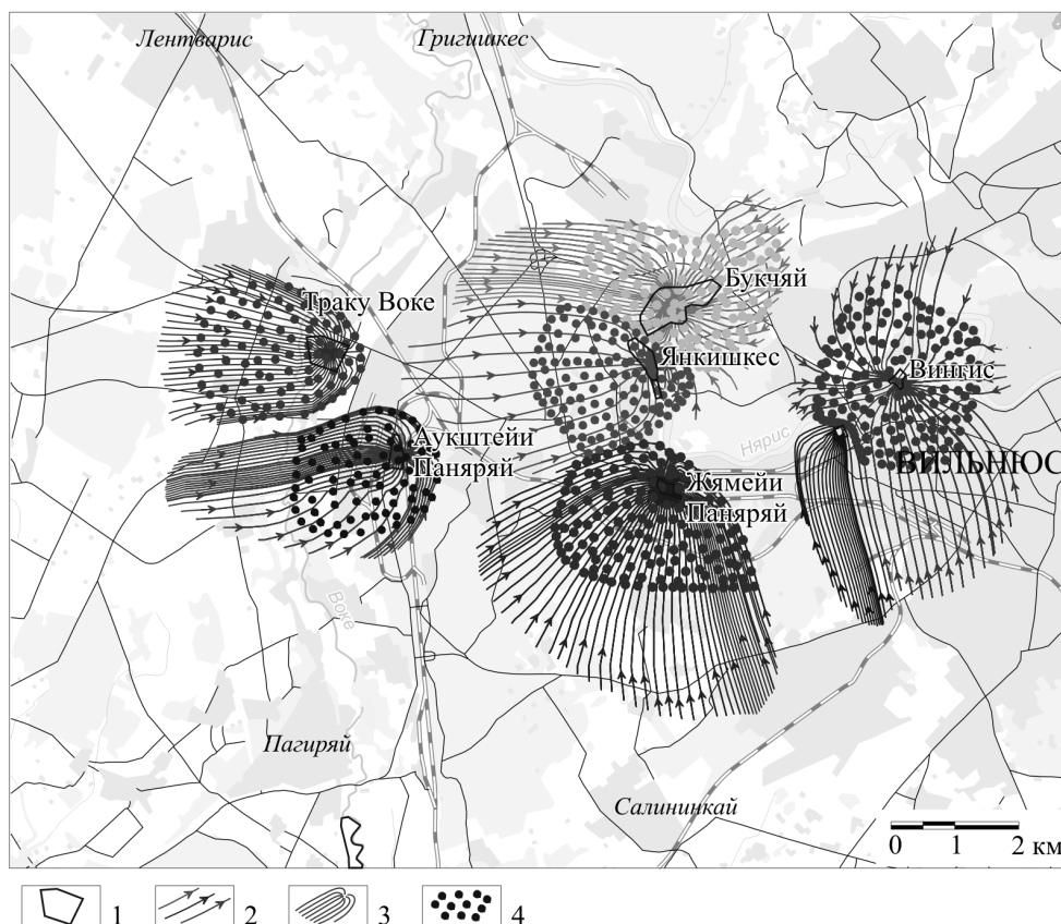
Рис 3. Области захвата водозаборами потока грунтовых и межпластовых вод по результатам моделирования
