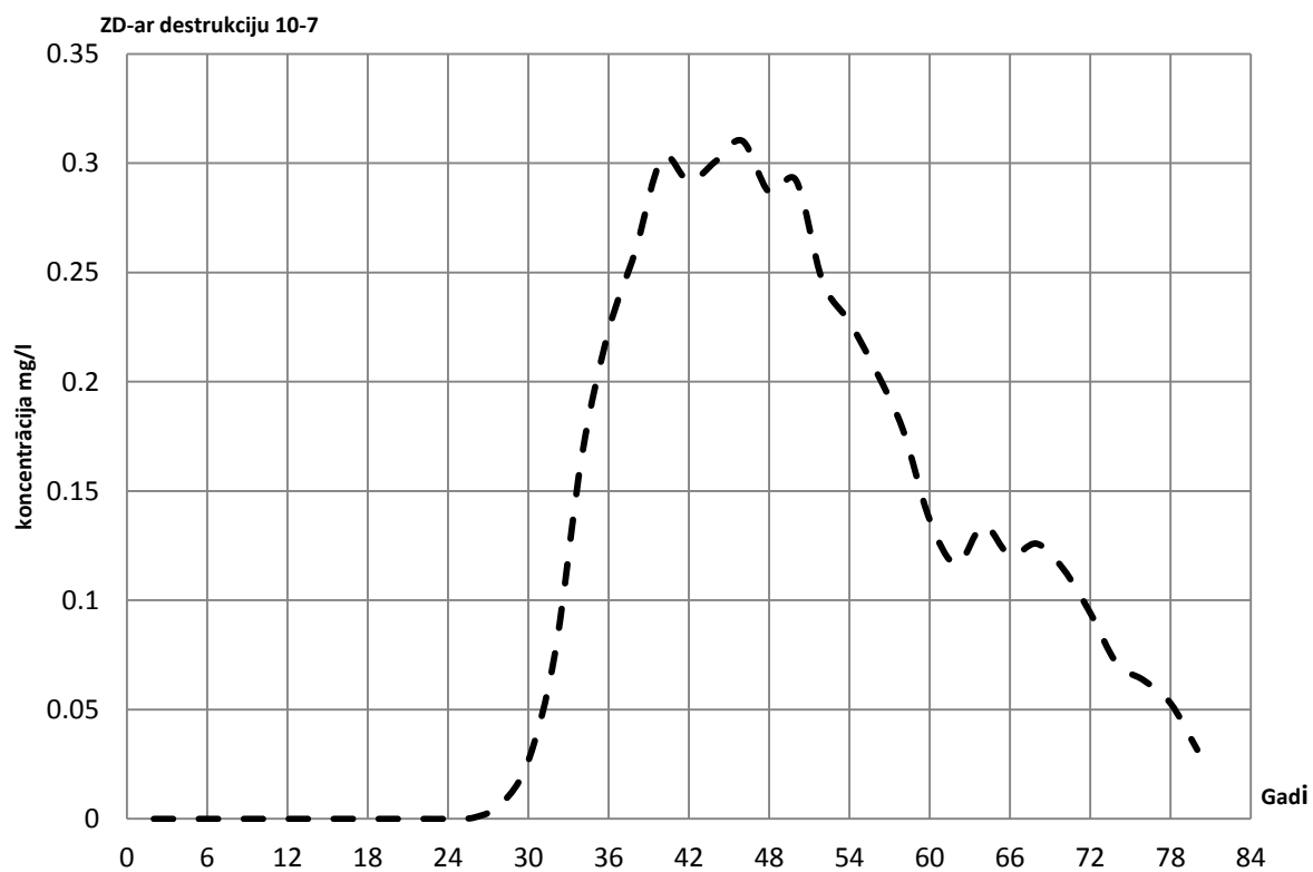
3.15. att. VAV koncentrāciju hidrogrāfi monitoringa urbumā Nr.10-7 Ziemeļu dīķim bez un ar VAV destrukcijas ievērošanu (laika atskaite no 2015. gada)
