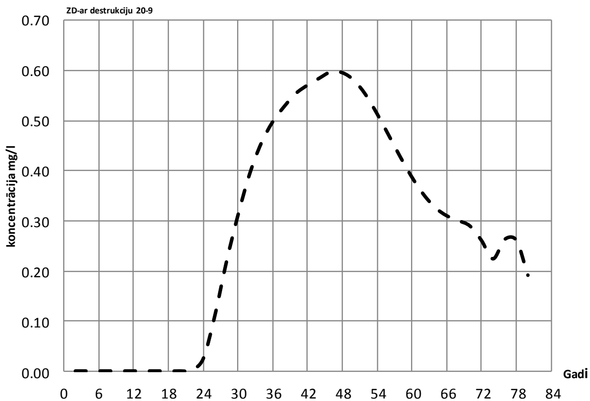
2.13. att. VAV koncentrāciju hidrogrāfi monitoringa urbumā Nr.20-9 Ziemeļu dīķim bez un ar VAV destrukcijas ievērošanu (laika atskaite no 2015. gada)
