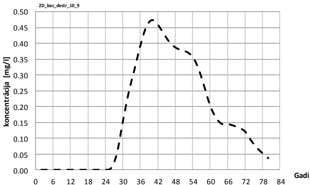
2.14. att. VAV koncentrāciju hidrogrāfi monitoringa urbumā Nr.10-9 Ziemeļu dīķim bez un ar VAV destrukcijas ievērošanu (laika atskaite no 2015. gada)
