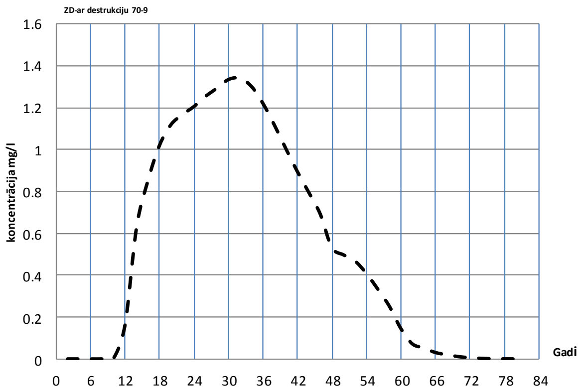
3.11. att. VAV koncentrāciju hidrogrāfi monitoringa urbumā Nr.70-9 Ziemeļu dīķim bez un ar VAV destrukcijas ievērošanu (laika atskaite no 2015. gada)
