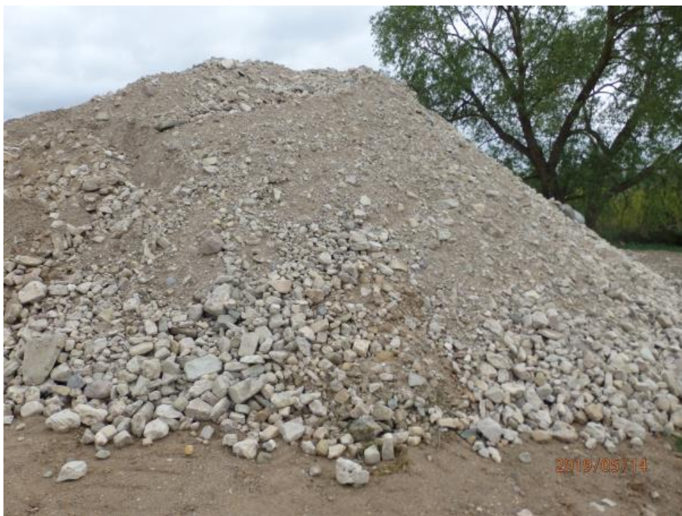
8. att. Izraktās grunts krautne ar irdenu drupiežu un nedrupinātu laukakmeņu maisījumu [1]
