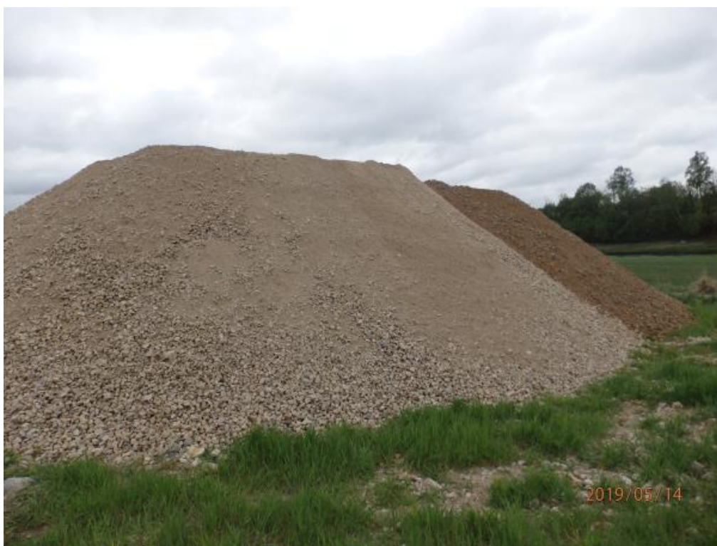
9. att. Izraktās grunts krautne ar irdenu drupiežu un drupinātu laukakmeņu maisījumu [1]
